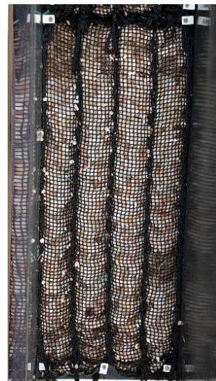
(b) 越流水深 0.3m、越流時間 3 時間後の状態
