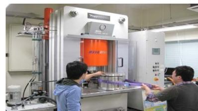
▲キュービックアンビル型高圧合成装置
