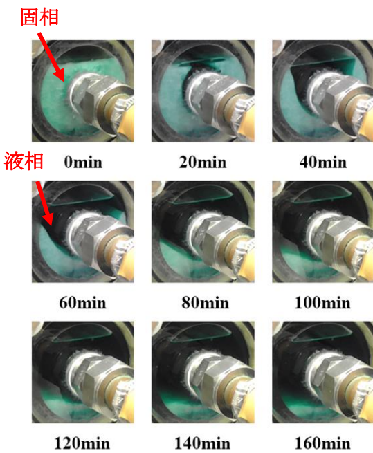
図2 融解プロセスの可視化画像
